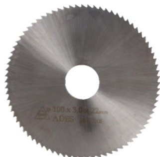
SERRA CIRCULAR - PRODUZIDA EM AÇO M2 - HSS COM DUREZA 63-65 HRC UTILIZADA PARA A OPERAÇÃO DE CORTE DE PEQUENAS PROFUNDIDADES, SOBRETUDO PARA FAZER RANHURAS E CORTAR PERFIS DE PAREDES FINAS
